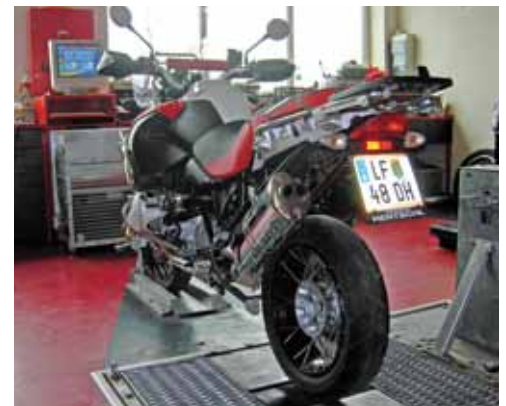
▲ Kontrolle am Cartec-Leistungsprüfstand von LBR Racing
